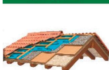
coperture e tetti ventilati
